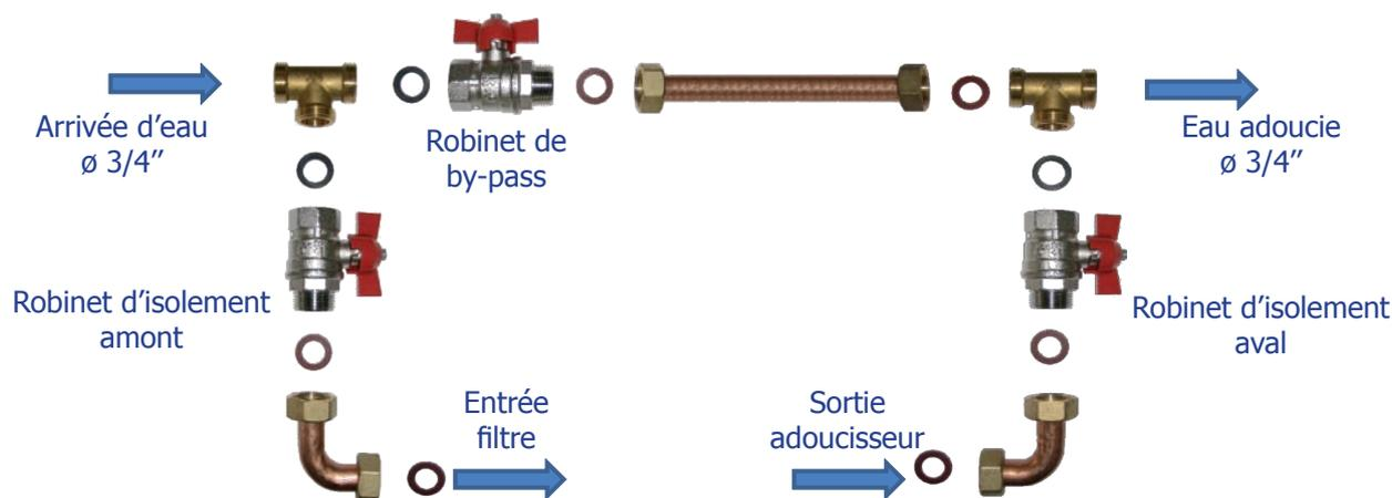
Visser un coude (la partie la plus courte) sur l'entrée du filtre en intercalant un joint fibre diamètre 3/4".
